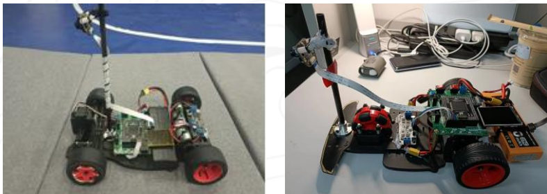
基于图像处理的循迹智能车（摄像头组）
